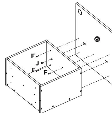
Parafuse o conector das corredeiras na frente e na base do gavetão, utilizando os parafusos 4x14(G).
