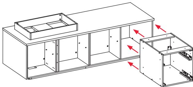
Deixe o corpo do gaveteiro faceado à lateral interna(16) e a base(2) do armário. Por dentro, faça a fixação com os parafusos 3,5x25(F), pelos furos dos montantes, laterais e base.
