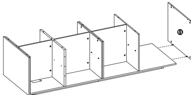
**Obs:** Após fixar a lateral externa arm/gav(11), ficará um "dente" para um dos lados, esse dente será o vão do puxador do gaveteiro. A lateral(11) pode ser fixada dos dois lados, deixando o dente para frente ou para trás, isso definirá o lado do armário (esquerdo ou direito) para utilização em conjunto com a mesa.
