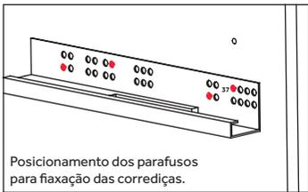
Posicionamento dos parafusos para fixação das corredeiras.
