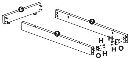
Junte as 2 partes fazendo a fixação pela chapa L(O) com o parafuso 4,8x13(H), aplicada no passo anterior.
